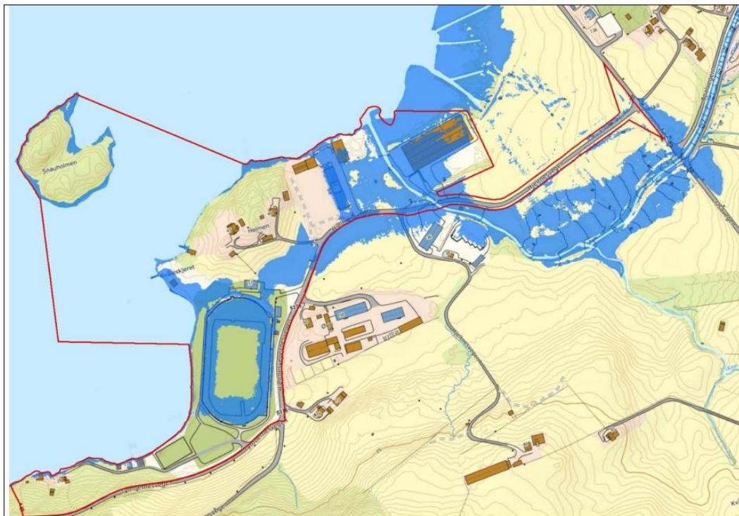
Figur 4-5 Omfang av flaum i Gauro ved planområdet for 200-årsflaum med 40% klimapåslag. Planområdet er vist med raud polygon [13]
