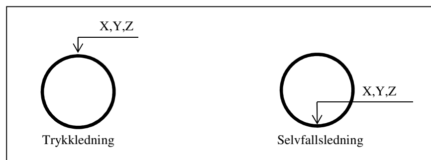
Figur 1. Måling av ledningshøyde.
