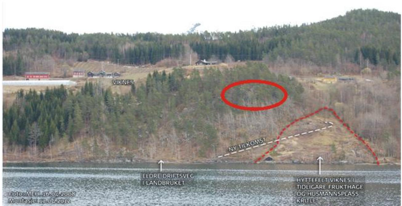
**Figur 20:** Fotomontasjen viser det planlagde hyttefeltet. Området innanfor den raude ringen på bildet, er det området der dei kritiske utløpspunkta for steinsprang er observert (f.fr. Figur 10 og Figur 19).
