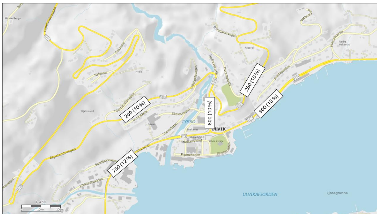
Figur 3-21: Dagens trafikkmengder (ÅDT) (2023-tal) i planområdet og omkringliggende vegnett. Tungebilandel i parentes. Trafikktal fra Statens vegvesen er basert på ei kombinasjon av teljing og skjønn. Innehold data under norsk lisens for offentlege data (NLOD) tilgjengeleggjort av Statens vegvesen.
